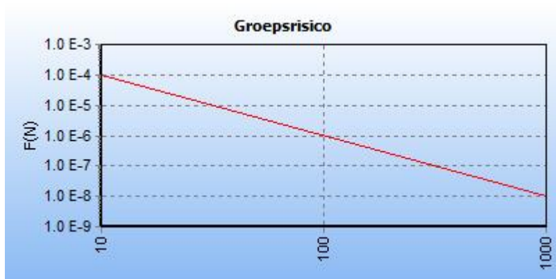
5.5 Figuur 5.5 FN curve voor 8208_leiding-W-533-13-deel-1 van N.V. Nederlandse Gasunie voor de kilometer tussen stationing 0.00 en stationing 1000.00
