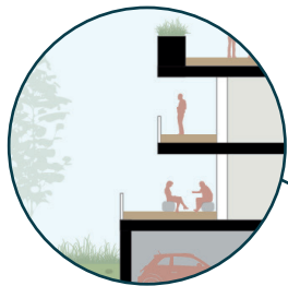
buitenruimtes zijn onderdeel van het hoofdvolume (loggia's of dakterrassen)
