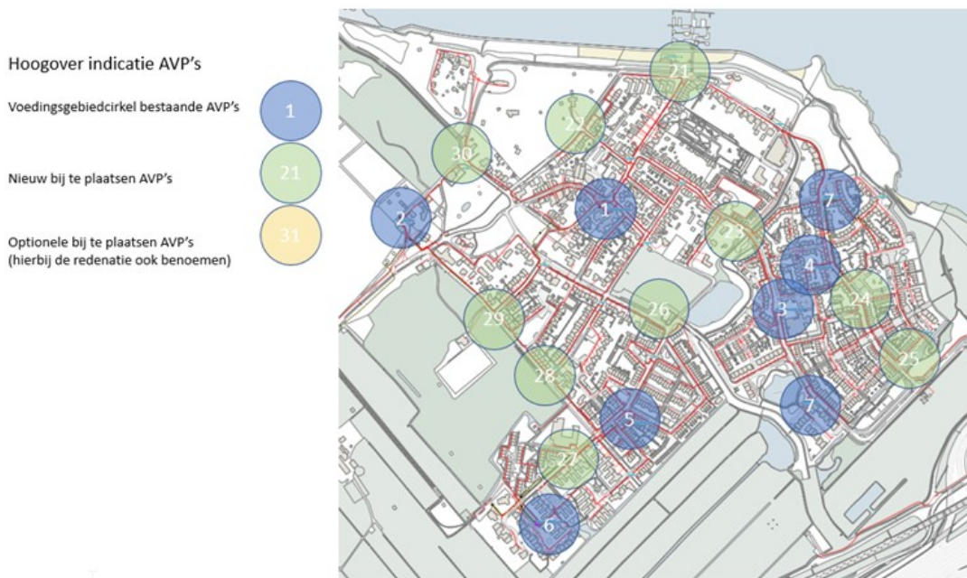
Figuur 6: Liander elektra, bij te plaatsen trafokasten
